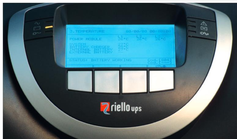
Multy Sentry est équipé d'un écran graphique (240x128 pixel rétro-éclairé) qui fournit les informations, les mesures, les états et les alarmes de l'ASI en plusieurs langues et affiche les formes d'onde et de tension / courant.
